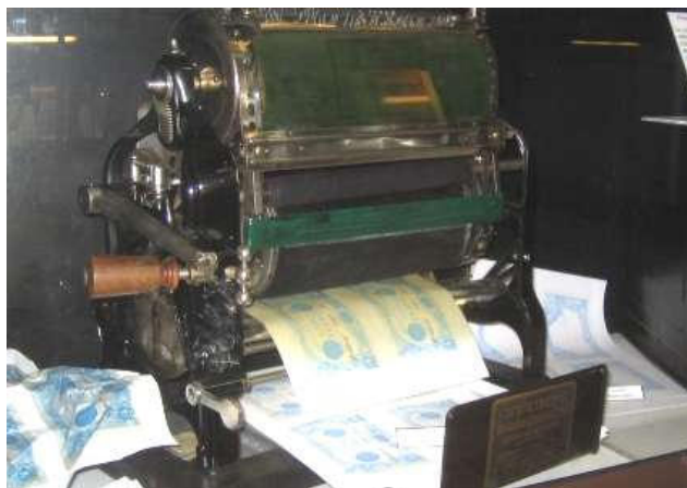
Presse d'imprimerie rotative Gestetner Cyclostyle n° 6 de 1880.
